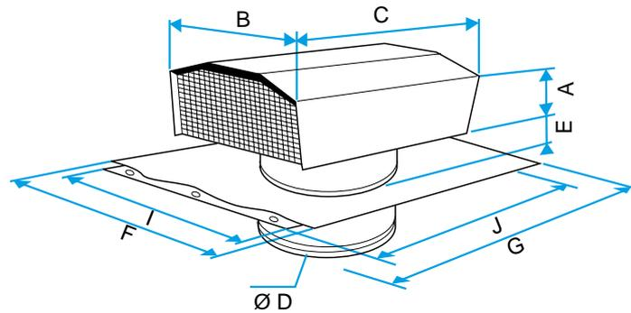
Schéma d'encombrement Sortie de Toit Standard
