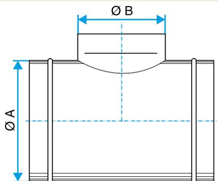
Schéma d'encombrement Té Equerre 90° en aluminium
