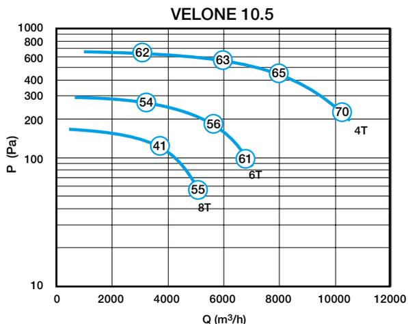
> courbes suivant NF EN ISO 5801, aspiration raccordée (Ø 450 mm),
