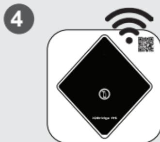
4 Connecter le produit à votre réseau Wi-Fi. La LED Bluetooth s'éteint et la LED Wi-Fi s'allume de manière fixe lorsque la passerelle est connectée au Wi-Fi.
