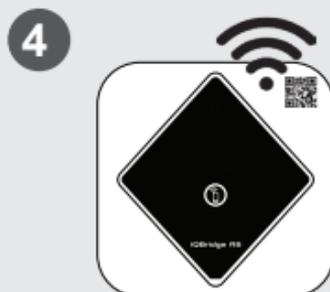
4 Povežite proizvod s Wi-Fi mrežom. Bluetooth LED žarulja se gasi, a Wi-Fi LED žarulja svijetli neprekidno plavo kada se pristupnik poveže s Wi-Fi mrežom.
