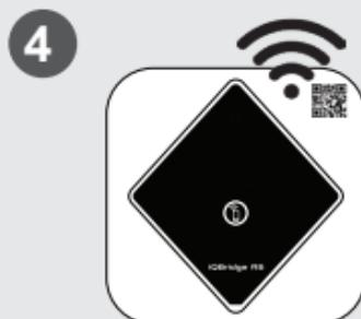
4 Koble produktet til ditt trådløse nettverk. Bluetooth-LED slukkes og trådløs LED lyser konstant blått når mottakeren er koblet til det trådløse nettverket.
