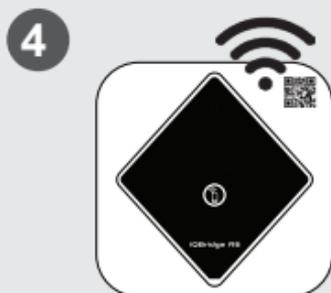
4 Conecte el producto a su red Wi-Fi. El LED Bluetooth se apaga y el LED wi-fi se enciende azul fijo cuando la pasarela está conectada a wi-fi.
