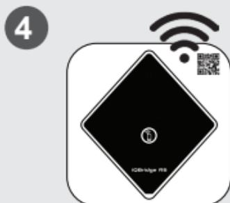
4 Conectați produsul la rețeaua dvs. Wi-Fi. LED-ul Bluetooth se stinge, iar LED-ul Wi-Fi devine albastru permanent odată ce gateway-ul este conectat la Wi-Fi.
