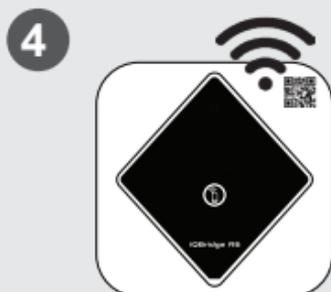
4 Connettere il prodotto alla rete Wi-Fi. Il LED del Bluetooth si spegne e il LED del Wi-Fi diventa blu fisso quando il gateway è connesso al Wi-Fi.
