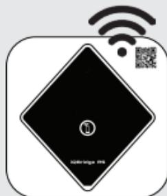
Verbinden Sie das Produkt mit Ihrem WLAN-Netzwerk. Die Bluetooth-LED schaltet sich aus und die WLAN-LED leuchtet dauerhaft blau, sobald das Gateway mit dem WLAN verbunden ist.
