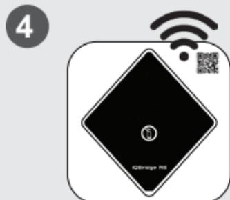
Повежите производ на своју Wi-Fi мрежу. Bluetooth ЛЕД лампица се искључује и ЛЕД лампица Wi-Fi постаје стално плава када је мрежни пролаз повезан на Wi-Fi.
