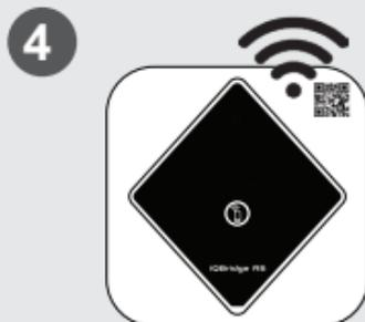
Ürünü Wi-Fi ağınıza bağlayın. Ağ geçidi Wi-Fi'ye bağlandığında Bluetooth LED'i kapanır ve Wi-Fi LED'i sabit mavi olur.
