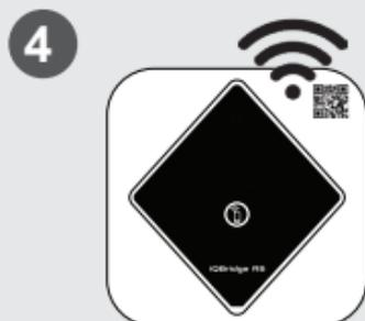
4 Tilslut produktet til dit wifi-netværk Bluetooth LED'en slukker, og wifi-LED'en lyser konstant blå, når gatewayen er sluttet til wifi.
