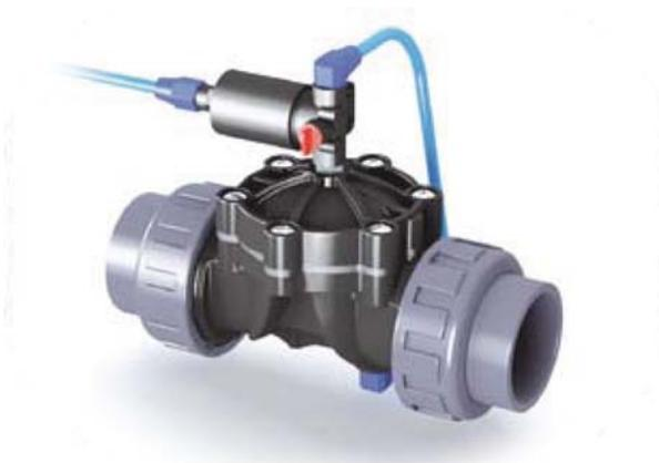
La vanne hydraulique de sécurité 1 1/2" est spécialement préconisée en sortie de vidange d'une vanne multivoies automatique d'un filtre à sable de piscine. Son utilisation évite les pertes d'eau quand la vanne change sa position de travail, en cas de défaillance électrique ou quand la vanne reste dans une position dans laquelle la piscine pourrait se vider. Cette vanne est recommandée dans les installations équipées de la vanne automatique SYSTEM VRAC.
