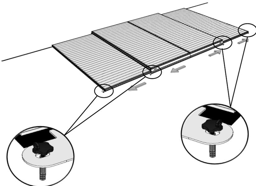
2. Chaque élément est équipé d'une fixation afin d'ancrer le module au sol.
