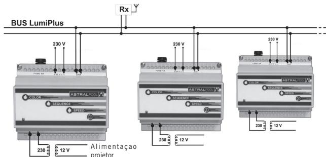
O número máximo de moduladores que podem ser sincronizados é de 10, e o número máximo de antenas que podemos colocar numa mesma instalação para obter a máxima cobertura será de 3 antenas.
