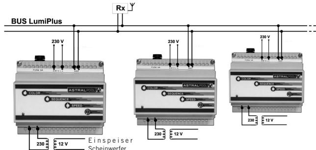
Man kann bis zu 10 Modulatoren synchronisieren, und die Höchstzahl von Antennen, die man in der gleichen Installation anbringen kann, um einen maximalen Empfang zu erreichen, sind 3 Antennen.
