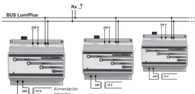
El número máximo de moduladores que se pueden sincronizar es 10, y el número máximo de antenas que podemos colocar en una misma instalación para tener el máximo de cobertura será de 3 antenas.
