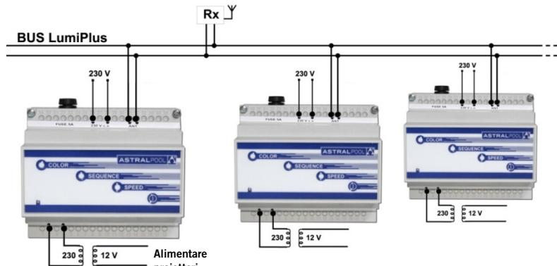
Il numero massimo di modulatori che si possono sincronizzare è di 10 unità, e il numero massimo di antenne che si possono collocare in un unico impianto, per ottenere il massimo di copertura, è di 3 unità.
