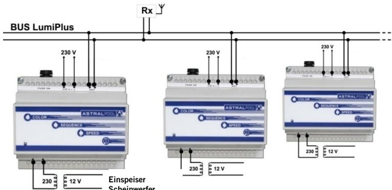
Man kann bis zu 10 Modulatoren synchronisieren, und die Höchstzahl von Antennen, die man in der gleichen Installation anbringen kann, um einen maximalen Empfang zu erreichen, sind 3 Antennen.
