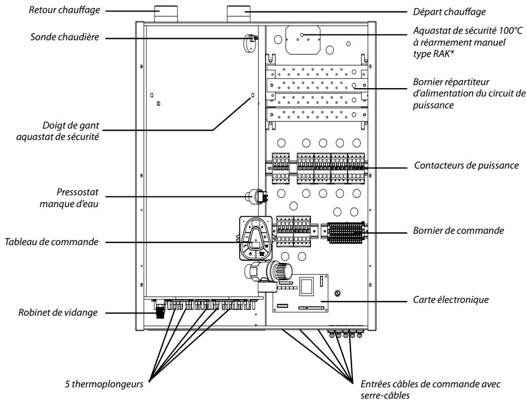
\* L'aquastat de sécurité 100°C type RAK à réarmement manuel est situé à l'arrière de la platine électrique avec réarmement par bouton poussoir accessible au travers de l'orifice situé sur la platine électrique.
