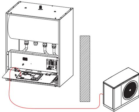
Prévoir au plus juste la longueur de liaison entre la pompe à chaleur et le pilote. Ne pas hésiter à recouper le câble à longueur pour **ÉVITER LES BOUCLES.**
