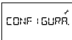
Sélectionnez le type de circuit raccordé (eau chaude sanitaire, radiateurs) et les modes de contrôle associés (sonde, thermostat).
