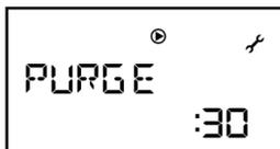
Le cycle de purge active le circulateur (et la vanne 3 voies si la production d'eau chaude est installée) à rythme alterné pour permettre le déplacement des bulles d'air accumulées aux points hauts et leur évacuation par le purgeur automatique du **Pilote**.
