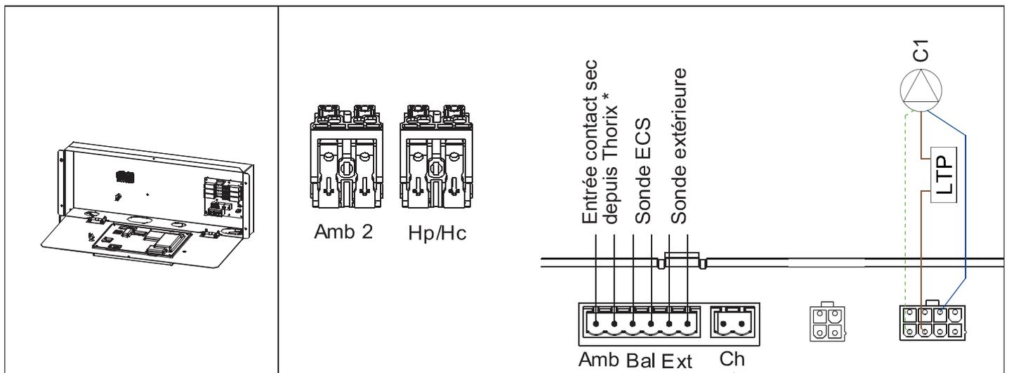
\* Sur le module Thorex, raccorder les deux fils sur la sortie Alarme et régler P219=1
