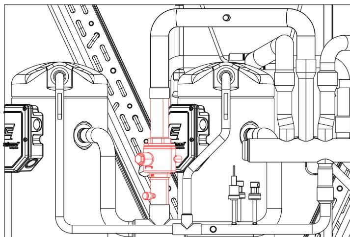
Une vanne d'arrêt est présente uniquement dans la HRC<sup>70</sup> 40 kW tri V pour la fabrication du produit sur la ligne d'assemblage. **En aucun cas cette vanne ne doit être fermée. Toutes détériorations de la machine avec manipulation de cette vanne annulent la garantie de la machine.**
