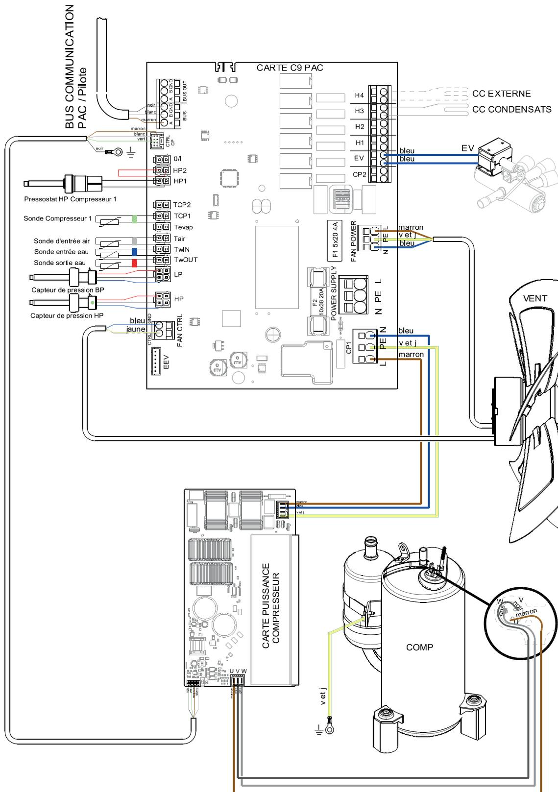
TwOUT - Sonde de température sortie d'eau
