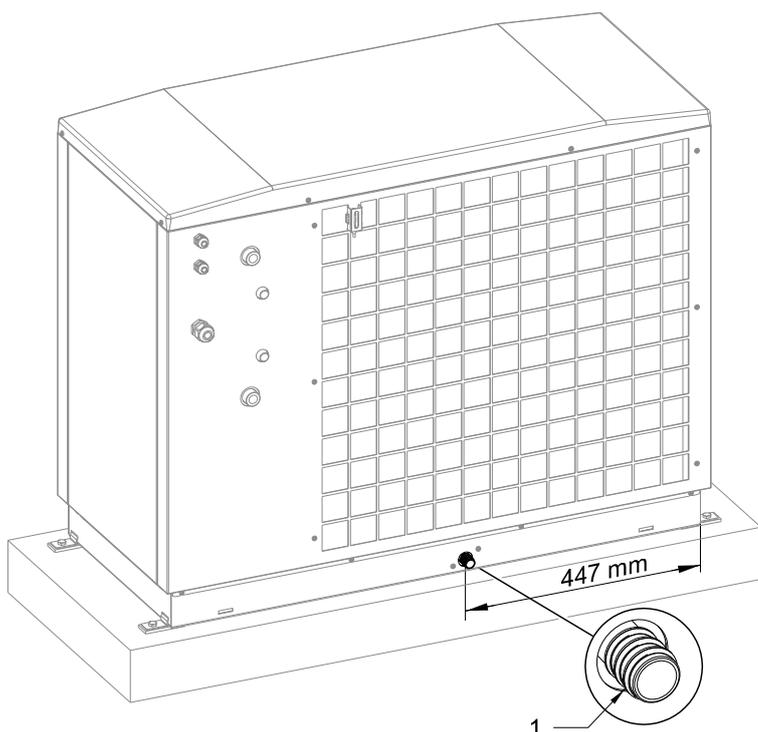
Lors du fonctionnement et en mode dégivrage, l'eau de condensation doit être évacuée. Pour que cette évacuation se fasse correctement, la gouttière et la sortie 1 doivent être exempts de corps étrangers (feuilles, brin d'herbes...).
