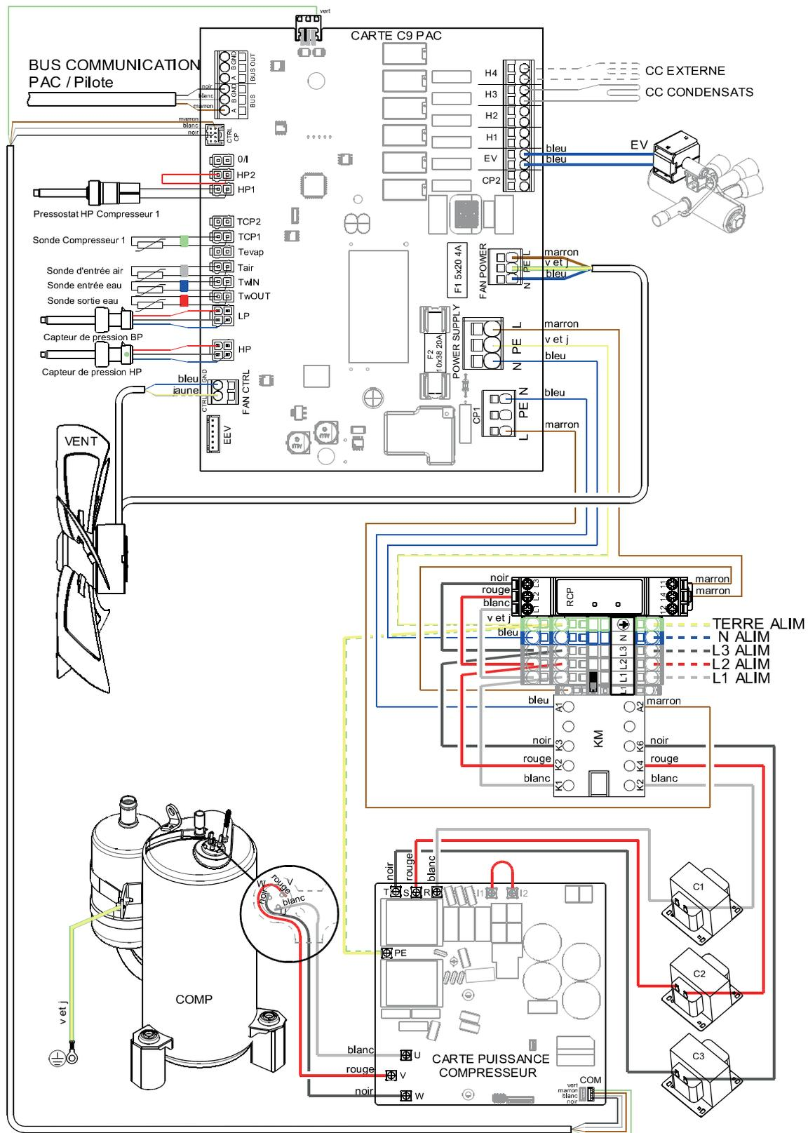
TwOUT - Sonde de température sortie d'eau
