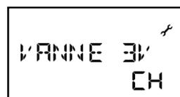
CH : la vanne passe en chauffage (position basse)
