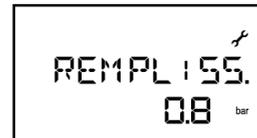
Pendant l'étape de remplissage, le **Pilote Hybrid Gaz** indique la pression mesurée dans le circuit chauffage.
