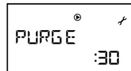
Le cycle de purge active le circulateur (et la vanne 3 voies si la production d'eau chaude est installée) à rythme alterné pour permettre le déplacement des bulles d'air accumulées aux points hauts et leur évacuation par le purgeur automatique du **Pilote Hybrid Gaz**.
