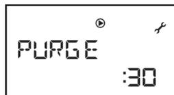
Le cycle de purge active le circulateur (et la vanne 3 voies si la production d'eau chaude est installée) à rythme alterné pour permettre le déplacement des bulles d'air accumulées aux points hauts et leur évacuation par le purgeur automatique du **Pilote Hybride Gaz**.
