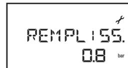
Pendant l'étape de remplissage, la chaudière indique la pression mesurée dans le circuit chauffage.
