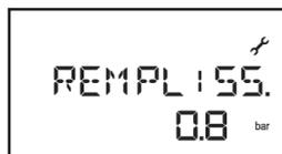
Pendant l'étape de remplissage, le **Pilote Hybride Gaz** indique la pression mesurée dans le circuit chauffage.
