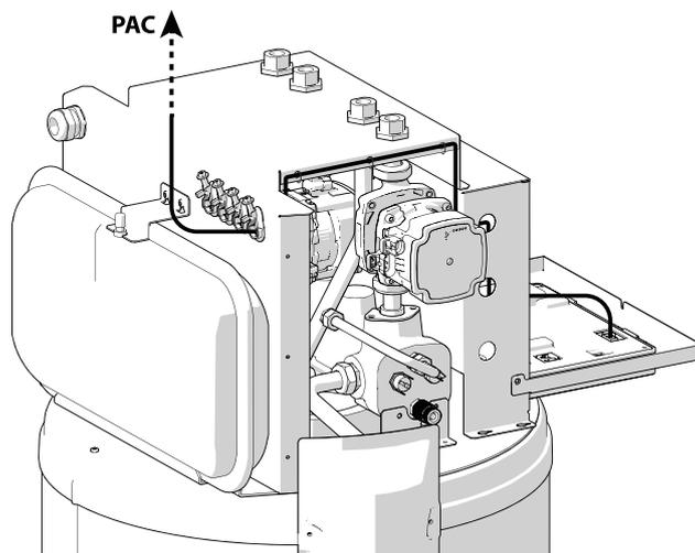
Prévoir au plus juste la longueur de liaison entre la pompe à chaleur et le pilote. Ne pas hésiter à recouper le câble à longueur pour **ÉVITER LES BOUCLES**.
