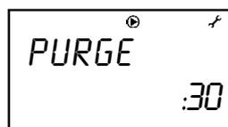
Le cycle de purge active le circulateur (et la vanne 3 voies si la production d'eau chaude est installée) à rythme alterné pour permettre le déplacement des bulles d'air accumulées aux points hauts et leur évacuation par le purgeur automatique du **Pilote**.
