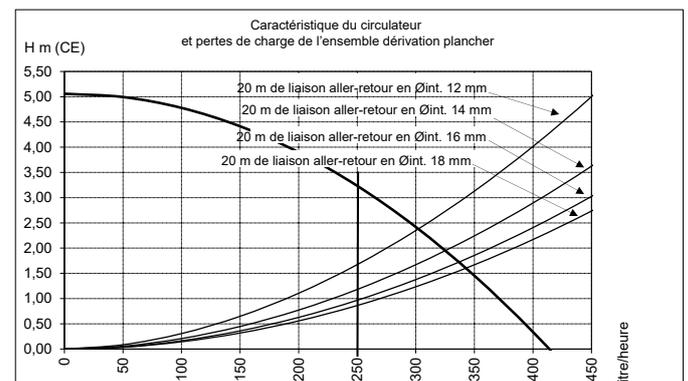
La longueur et le diamètre de la liaison hydraulique aller/retour entre le module de dérivation plancher et le chauffe eau thermodynamique doivent être adaptés au circulateur pour que le débit prélevé dans le plancher soit supérieur à 250 l/h.
