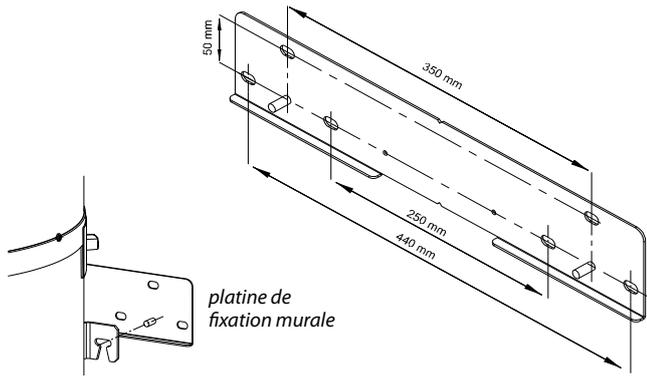
Pour une fixation murale robuste et parfaitement verticale, il convient d'utiliser la (les) platine(s) de fixation murale (en option). Cette platine est pré-percée avec différents entraxes de fixation : 250 mm, 350 mm ou 440 mm. Cela permet d'une part, une fixation murale plus robuste en utilisant si besoin est, 4 points de fixation au lieu de 2, et d'autre part, un pré-positionnement parfaitement horizontal à l'aide d'un niveau.
