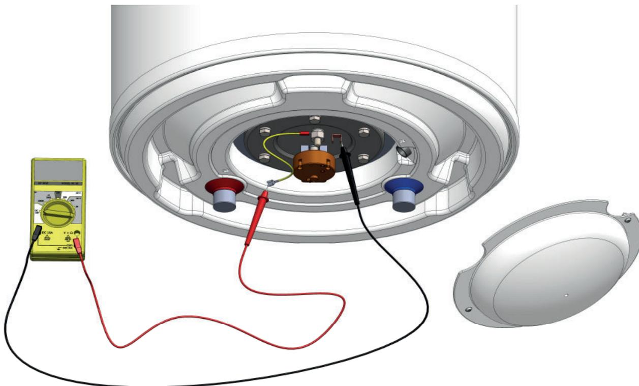
Si l'intensité est  $>0,3$  mA, l'anode est opérationnelle, si l'intensité est  $<0,3$  mA, vérifier visuellement l'anode.
