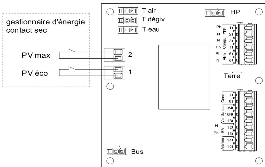
Cette fonction permet de fonctionner en autoconsommation et d'utiliser préférentiellement l'énergie produite par l'installation photovoltaïque pour alimenter la pompe à chaleur, ainsi que la résistance chauffante et chauffer l'eau du ballon. Le raccordement se fait entre le boîtier de gestion d'énergie (non fourni) et les connecteurs 1 et 2 de la carte électronique.
