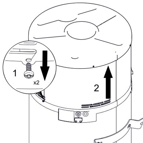
Pour accéder à la pompe à chaleur et aux raccords électriques: Dévisser partiellement (ou retirer) les 2 vis (C) qui maintiennent la virole au bac inférieur du bloc thermodynamique.
