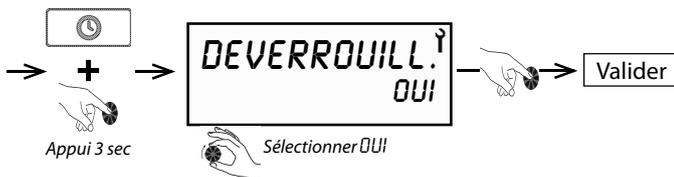
• Lorsque le verrouillage est activé, seuls l'accès au déverrouillage et le réarmement des défauts sont possibles.
