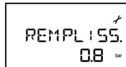
Pendant l'étape de remplissage, le **Pilote Z1** indique la pression mesurée dans le circuit chauffage.
