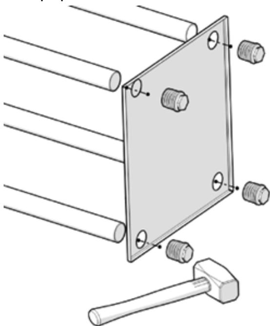
3. Régler la hauteur de chaque pied de réglage à l'aide des vis pour mettre à niveau le pilote par rapport au sol, à l'aide du niveau à bulle
