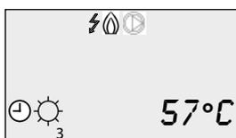
La température de la sonde chaudière 57°C apparaît. Une rotation de la molette fait apparaître la consigne (Co) en cours.
