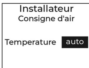
Permet de régler le niveau de température de l'air soufflé par le **Zé7**, pour chauffer la maison.
