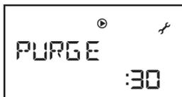
Le cycle de purge active les circulateurs à rythme alterné pour permettre le déplacement des bulles d'air accumulées aux points hauts et leur évacuation par le purgeur automatique du pilote.
