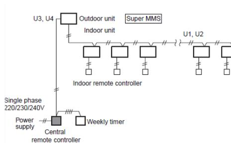
A gauche le schéma de raccordement classique de la commande centralisée avec son horloge.
