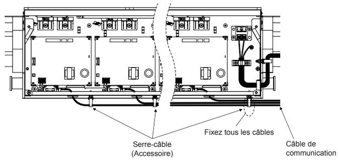
■ Schéma des câbles du système
