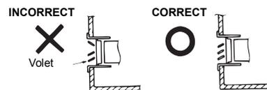
2 Réglez le volet sur un angle égal ou inférieur à 40°. Si l'angle est supérieur à 40°, des gouttelettes risquent de tomber.
