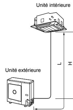
Figure de l'installation double simultanée
