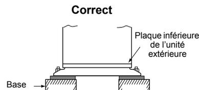
Soutien de la surface inférieure de la patte de fixation qui est en contact avec et dessous la plaque inférieure de l'unité extérieure.
