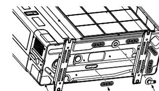
Trou défonçable Bouchon en caoutchouc étanche
