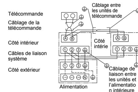
\* Utilisez un câble blindé à 2 noyaux (MVVS 0,5 à 2,0 mm<sup>2</sup> ou plus) pour le câblage de la télécommande dans les systèmes double simultanément afin d'éviter des problèmes de bruit. Veillez à raccorder les deux extrémités du câble blindé aux fils de terre.
