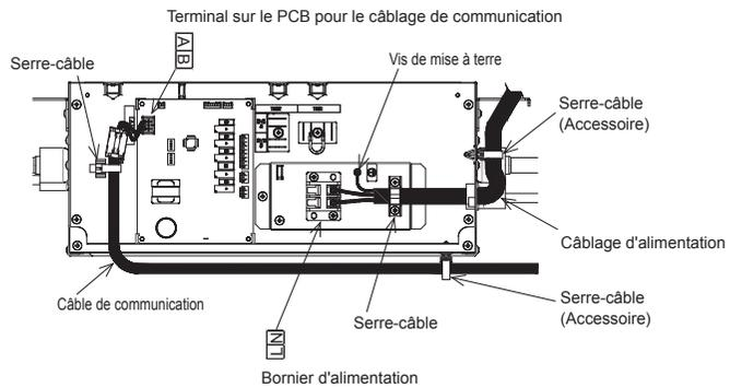
Pour le câble de communication, fixez le filtre de serre-joint (accessoire) comme sur l'image ci-dessous.
