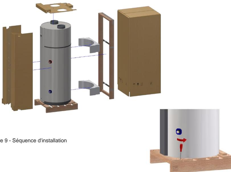
Figure 9 - Séquence d'installation
