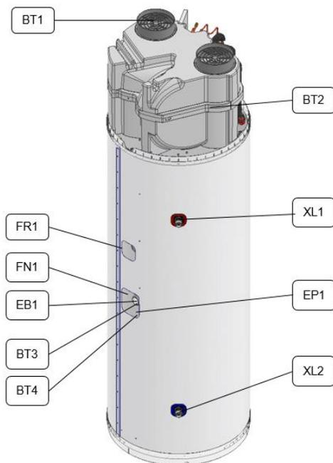
Figure 5 – Conception du réservoir, du condenseur et des composants connexes
