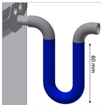
Figure 11 - Diagramme du siphon de vidange
