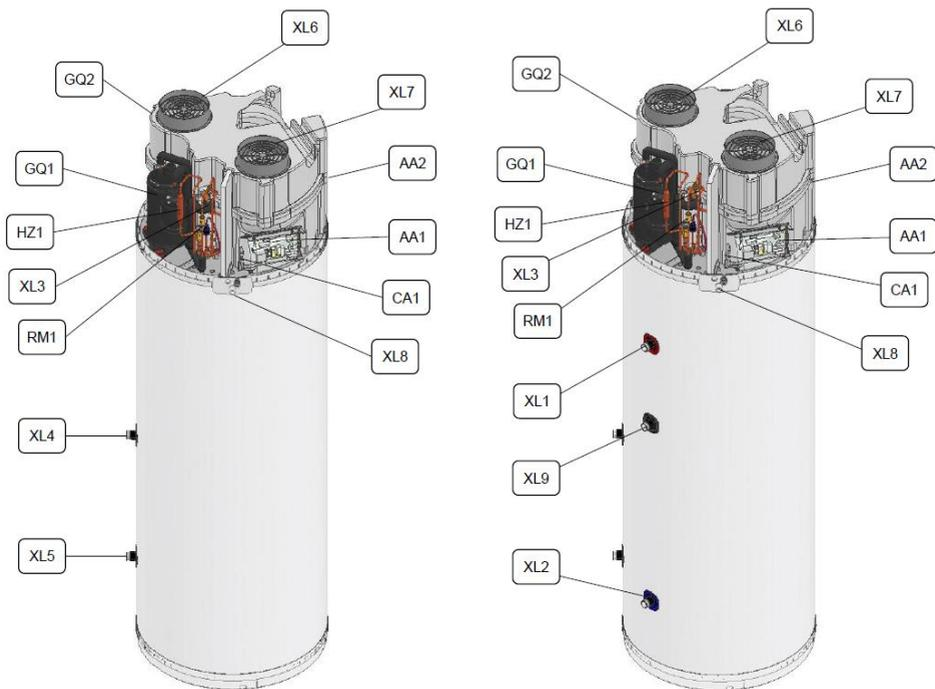
Figure 4 – Conception du circuit de chauffage et des principaux composants. Le modèle à droite affiche une option solaire avec connexion de circulation secondaire.
