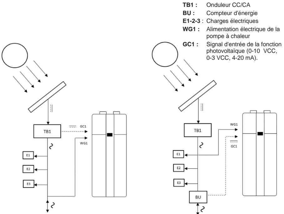
Figure 19 - Installation PV 1 : signal de commande de l'onduleur.
