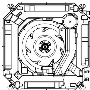
Pensez à retirer le ruban installé pour le transport entre le ventilateur et l'évasement.
