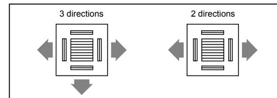
Utilisez un kit de plaque de blindage (vendu séparément) pour modifier l'orientation des sorties d'air. Les directions des sorties de flux d'air sont limitées. Suivez les instructions du manuel d'installation fourni avec le kit de plaque de blindage.
