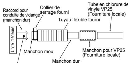
**Produit adhésif interdit :** Utilisez le tuyau flexible et le collier de serrage fournis pour raccorder la conduite de vidange au manchon d'évacuation prévu sur l'unité intérieure. L'utilisation d'un adhésif attaquera le manchon et provoquera des fuites d'eau.
