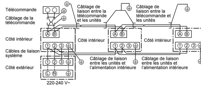
\* Utilisez un câble blindé à 2 noyaux (MVVS 0,5 à 2,0 mm<sup>2</sup> ou plus) pour le câblage de la télécommande dans les systèmes double synchrone et triple synchrone afin d'éviter des problèmes de bruit. Veillez à raccorder les deux extrémités du câble blindé à la terre.
