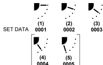
\* Lorsque l'orientation (4) ou (5) est sélectionnée, une condensation peut se former en mode de refroidissement.
