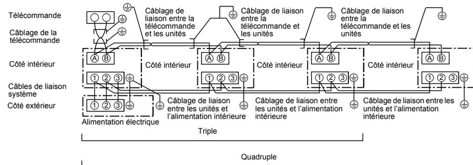
\* Utilisez un câble blindé à 2 noyaux (MVVS 0,5 à 2,0 mm<sup>2</sup> ou plus) pour le câblage de la télécommande dans les systèmes double simultané, triple simultané et quadruple simultané afin d'éviter des problèmes de bruit. Raccordez les deux extrémités du câble blindé aux fils de terre.
