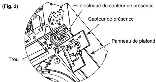
3. Attachez le capteur de présence au panneau de plafond et fixez-le en serrant la vis à l'angle du panneau de plafond. (Fig. 4)
