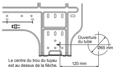
1. Après avoir déterminé l'emplacement du trou du tube sur la plaque de montage (➔), percer l'ouverture du tube (Ø65 mm) légèrement inclinée vers le bas vers le côté extérieur.
