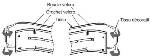
4. Insérez le tissu dans le côté haut et le côté bas de la grille d'entrée d'air.
