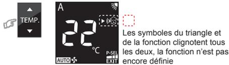
2. Entrez dans le réglage SILENCE en appuyant sur la touche MENU. L'icône du triangle devient fixe et la fonction de réglage se met à clignoter.
