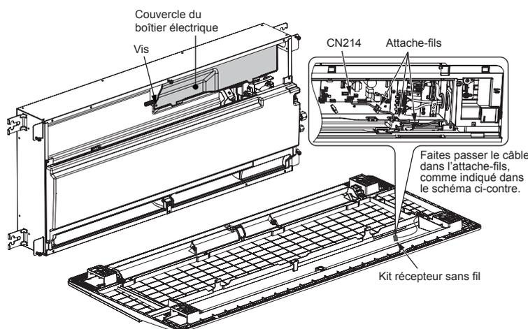
Câblage (à titre indicatif uniquement, l'orientation de l'unité intérieure ne correspond pas à l'orientation réelle)
