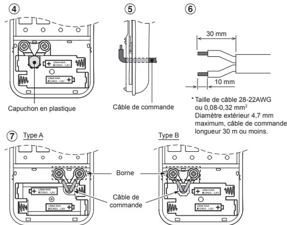
\* Les bornes pour le câblage peuvent se trouver à droite (type A) ou à gauche (type B), selon le contrôleur emballé dans le carton.
