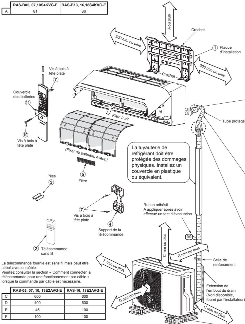
Pour la tuyauterie arrière gauche, inférieure gauche et gauche
