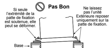
Réglez la marge Extérieure du boulon d'ancrage sur 15 mm ou moins.
