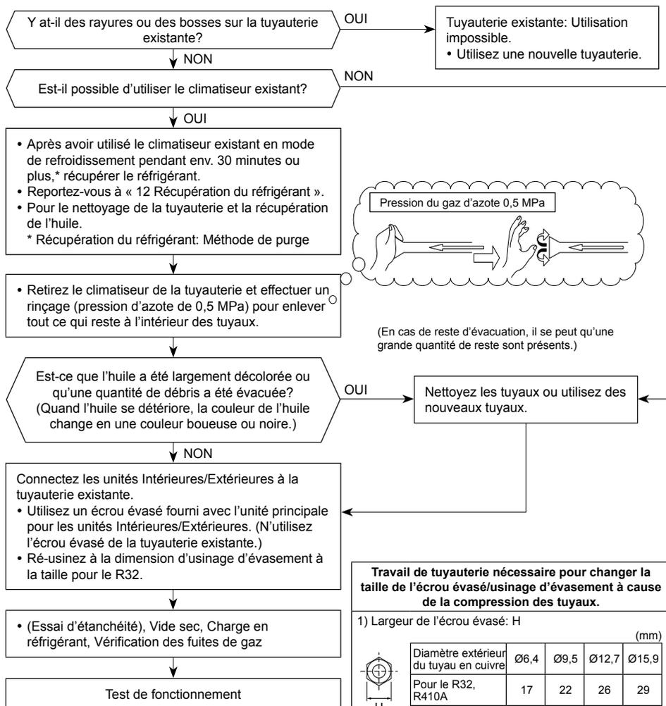
**Travail de tuyauterie nécessaire pour changer la taille de l'écrou évasé/usinage d'évasement à cause de la compression des tuyaux.**
