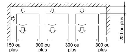
La hauteur de l'obstacle doit être inférieure à celle de l'unité Extérieure.
