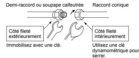
2. Comme illustré sur la figure, assurez-vous d'utiliser deux clés pour desserrer ou serrer l'écrou évasé de la soupape sur le côté gaz. Si vous utilisez une seule clé à molette, vous ne pouvez pas serrer l'écrou évasé au couple requis. D'autre part, utilisez une seule clé à molette pour desserrer ou serrer l'écrou évasé de la soupape sur le côté liquide.
