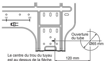
1. Après avoir déterminé l'emplacement du trou du tube sur la plaque de montage (➔), percer l'ouverture du tube (Ø65 mm) légèrement inclinée vers le bas vers le côté extérieur.
