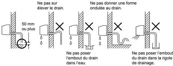
2. Mettre de l'eau dans le bassin de drainage et s'assurer que l'eau est drainée à l'extérieur.
