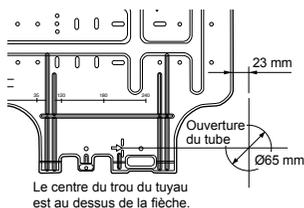
1. Après avoir déterminé l'emplacement du trou du tube sur la plaque de montage (➔), percer l'ouverture du tube (Ø65 mm) légèrement inclinée vers le bas vers le côté extérieur.
