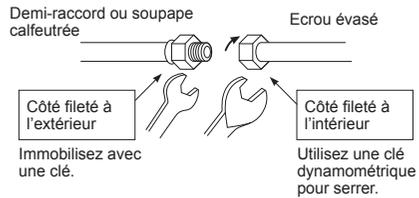
**2** Comme illustré sur la figure, assurez-vous d'utiliser deux clés pour desserrer ou serrer l'écrou évasé de la soupape sur le côté gaz. Si vous utilisez une seule clé à molette, vous ne pouvez pas serrer l'écrou évasé au couple requis.
