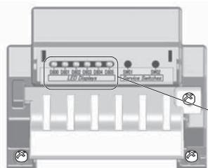
\* Les LED et les commutateurs sont situés en haut à droite du circuit imprimé de l'unité extérieure comme indiqué sur la figure de droite.
