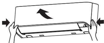
2. Appuyez sur les deux leviers gauche et droit du filtre à air et soulevez ce dernier légèrement, puis poussez-le vers le bas pour l'extraire du support de filtre.
