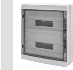
Gamme IP65 de coffrets étanches de 8 à 72 modules avec porte transparente fumée et équipés de borniers multipolaires de câblage à vis, 80 A, IP20.. Les principales caractéristiques techniques sont : façade et panneau arrière réversibles, cadres et plastrons ouverts amovibles et portes détachables avec ouverture jusqu'à 180 ° et accessoire de verrouillage.. Les borniers permettent de créer un câblage simple et net en réduisant le temps d'installation du coffret..
