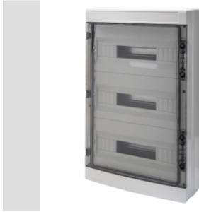
Gamme IP65 de coffrets étanches de 8 à 72 modules avec porte transparente fumée et équipés de borniers multipolaires de câblage à vis, 80 A, IP20.. Les principales caractéristiques techniques sont : façade et panneau arrière réversibles, cadres et plastrons ouverts amovibles et portes détachables avec ouverture jusqu'à 180 ° et accessoire de verrouillage.. Les borniers permettent de créer un câblage simple et net en réduisant le temps d'installation du coffret..
