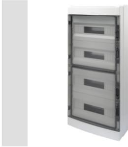
Gamme IP65 de coffrets étanches de 8 à 72 modules avec porte transparente fumée et équipés de borniers multipolaires de câblage à vis, 80 A, IP20.. Les principales caractéristiques techniques sont : façade et panneau arrière réversibles, cadres et plastrons ouverts amovibles et portes détachables avec ouverture jusqu'à 180 ° et accessoire de verrouillage.. Les borniers permettent de créer un câblage simple et net en réduisant le temps d'installation du coffret..
