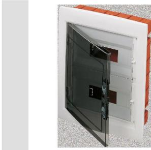
Les coffrets encastrables avec protection IP40 sont disponibles dans différentes tailles allant de 8 à 12 modules, et sont équipés de borniers multipolaires de câblage à vis, 80 A, IP20.. Ils sont disponibles avec une porte transparente fumée (particulièrement adaptée pour le secteur commercial et industriel) ou une porte pleine (idéale pour les applications domotiques). Les borniers permettent de créer un câblage simple et net en réduisant le temps d'installation du coffret..
