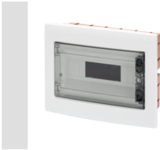
La gamme de coffrets encastrables avec protection IP40 propose des tailles allant de 2 à 72 modules, disponibles avec une porte transparente fumée (particulièrement adaptée pour le secteur commercial et industriel) ou une porte pleine (idéale pour les applications domotiques).. Ils peuvent être équipés de borniers multipolaires ou unipolaires de capacité 80 A à 125 A avec câblage à vis. Ils permettent de créer un câblage simple et net en réduisant le temps d'installation du coffret.
