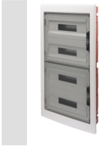
Les coffrets encastrables avec protection IP40 sont disponibles dans différentes tailles allant de 8 à 72 modules, et sont équipés de borniers multipolaires de câblage à vis, 80 A, IP20.. Ils sont disponibles avec une porte transparente fumée (particulièrement adaptée pour le secteur commercial et industriel) ou une porte pleine (idéale pour les applications domotiques). Les borniers permettent de créer un câblage simple et net en réduisant le temps d'installation du coffret..
