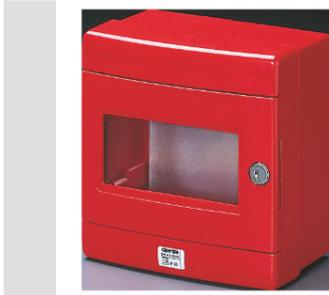
Coffret étanche rouge RAL 3000 pour coupure d'urgence et applications spéciales avec plaque de fond métallique galvanisée. Le marteau bris de glace proposé en accessoire, le plastron plombable et la matière sans halogène en font une solution idéale pour les applications dans les espaces ouverts au public.
