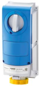
Gamme de produits constituée de prises industrielles conformes IEC 60309, avec verrouillage mécanique par commutateur rotatif, pour une utilisation individuelle ou groupée sur bases modulaires. La robustesse des produits, leur résistance face aux agressions des principaux agents chimiques et atmosphériques, ainsi que l'indice de protection élevé IP 66 permettent une installation dans des environnements difficiles, avec des conditions atmosphériques difficiles.
