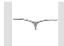
Support simple tête de poteau en tube acier galvanisé, 3 ou 4 mm d'épaisseur, peint avec de la poudre polyester. Fourni avec trois vis de blocage M8 en acier inoxydable pour la fixation sur des poteaux de diamètre de 60 mm.
